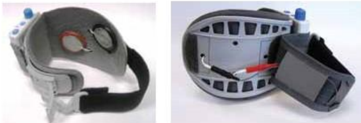
Рис 9 и 10: Замена электродов (вид изнутри и снаружи)
